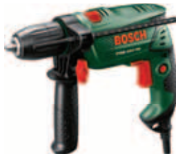
Ударна бормашина Bosch PSB 450 RE мощност: 500W обороти на празен ход: 0-3000 об./мин диаметър на пробиване в бетон/стомана/ дърво: 10/8/25 мм хх 23793583
