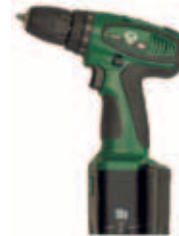
Акумулаторен винтоверт STATUS CT18 напрежение: 18V батерия: 1.2Ah/ Ni-Cd макс.въртящ момент: 42Nm обороти на празен ход: 0-1400 об./мин хх 06004248
