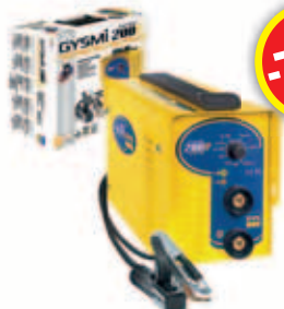
Преносим инверторен електрожен GYSMI 200 P мрежово напрежение: 230 V мрежов предпазител: 16 A заваръчен ток: 10-200 A размер електроди: 1.5- 5.00 мм xx 06022051
