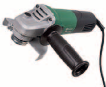
STATUS Ъглошлайф SH 125FSE мощност: 850 W об. на празен ход: 3000-11000 диаметър на диск: 125 мм Електронно регулиране на оборотите хх 06037345
