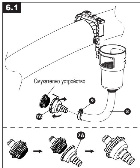
Окачете повърхностния скимер за кръгъл басейн върху горния надуваем пръстен на кръглия басейн и след това развийте на ръка застопоряващата гайка **5** обратно на часовниковата стрелка. Натиснете опорната рамка на кръглия басейн, за да фиксирате повърхностния скимер за кръгъл басейн върху кръглия басейн. (Натиснете бутона за освобождаване, за да освободите задната опорна рамка **3** на кръглия басейн).
