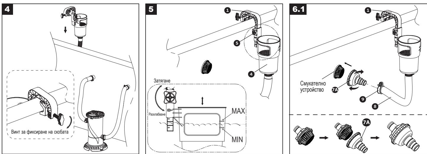
Окачете повърхностния скимер за басейн с опорна рамка върху горния прът на басейна с опорна рамка и след това завъртете винта за фиксиране на скобата по часовниковата стрелка, за да затегнете скимера на ръка.
