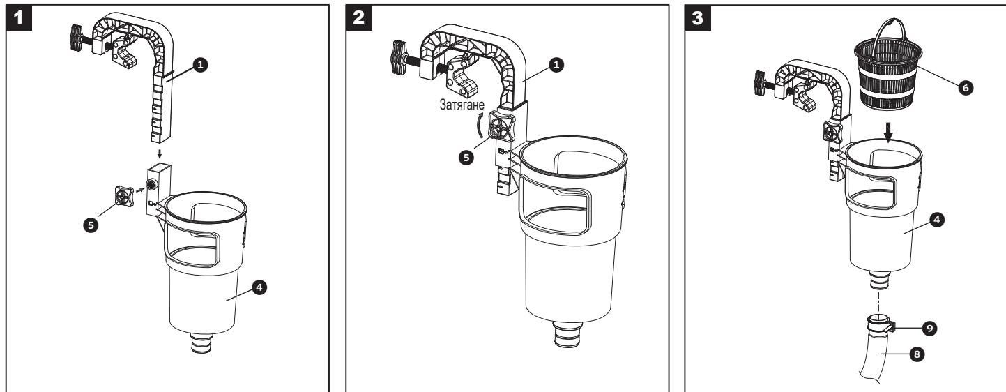
Вкарайте рамковия държач **1** на басейна с опорна рамка в кошницата на скимера **4**. Поставете застопоряващата гайка **5** върху отвора с резба на патрона на скимера **4**.
